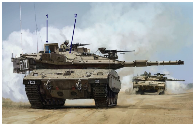
3 pav. Tankas „Merkava IV“ su aktyviosios apsaugos sistema „Trophy“ (1 – užtaisų paleidimo įrenginys, 2 – radaras)
