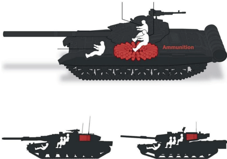
1 pav. Amunicijos vieta sovietiniuose ir Vakarų tankuose. Viršuje – T-72, apačioje – „Leopard 2“ ir „Abrams“
