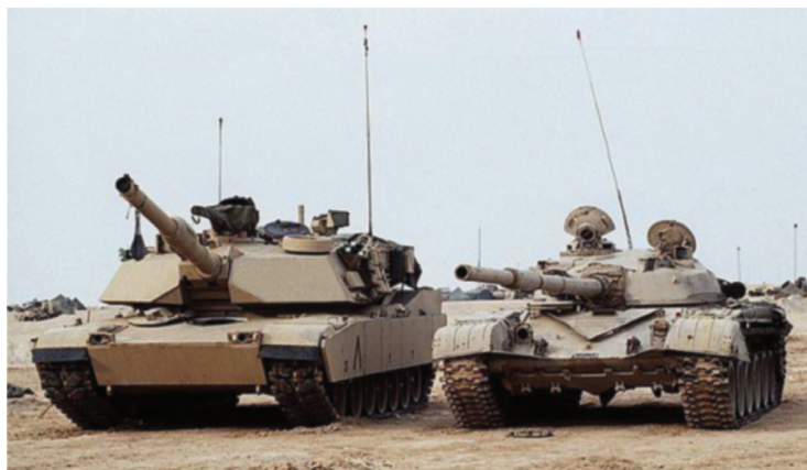
2 pav. Sovietinio ir Vakarų tankų gabaritų palyginimas (kairėje – „Abrams“ M1A1, dešinėje – T-72M1)
